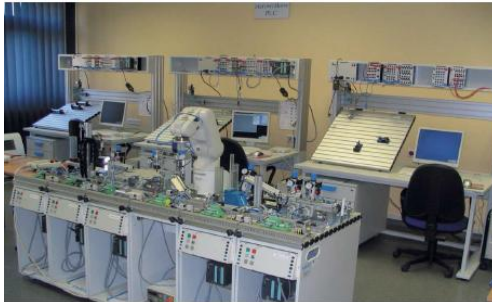
Model linii produkcyjnej z robotem Mitsubishi w pracowni mechatronicznej CKP
