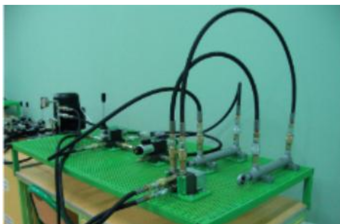
Stanowisko do montażu układów hydrauliki
