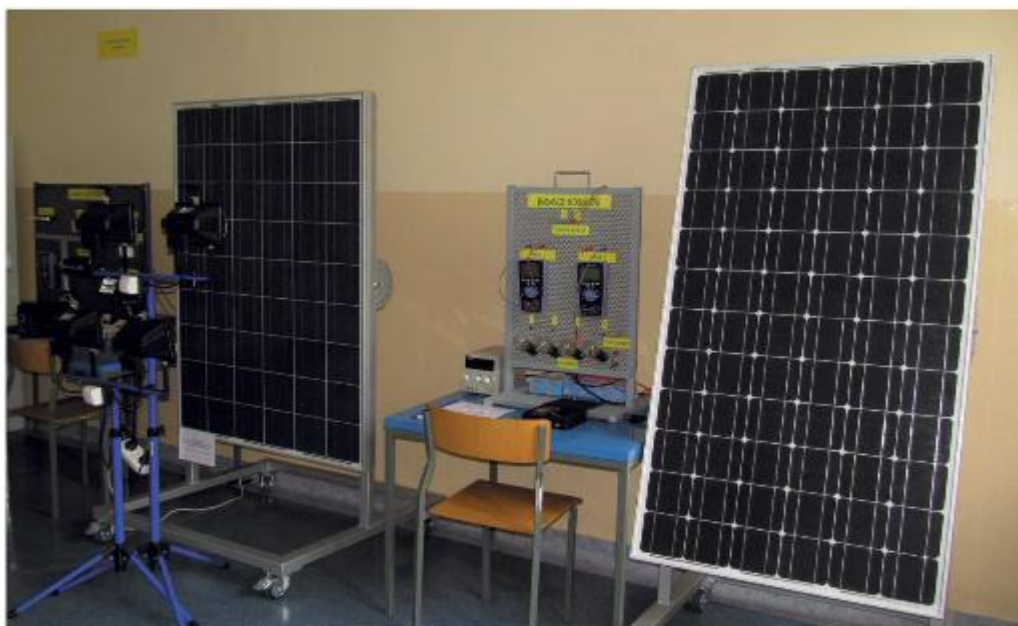
Stanowisko do badania modułów fotowoltaicznych
