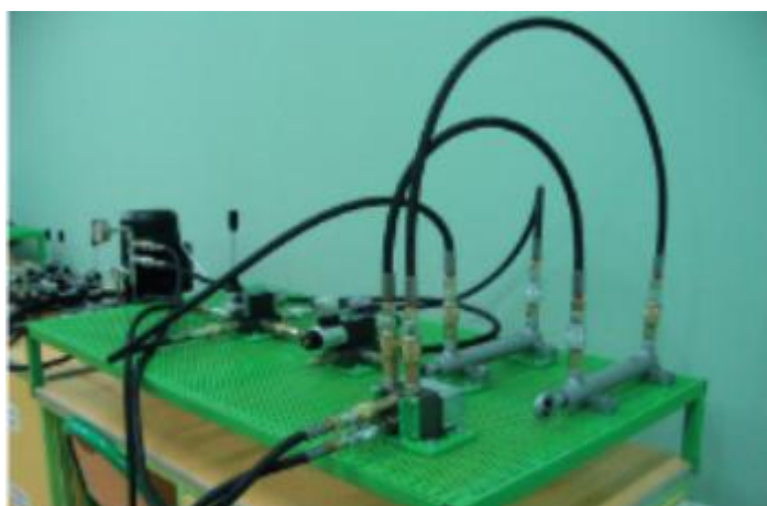
Stanowisko do montażu układów hydrauliki
